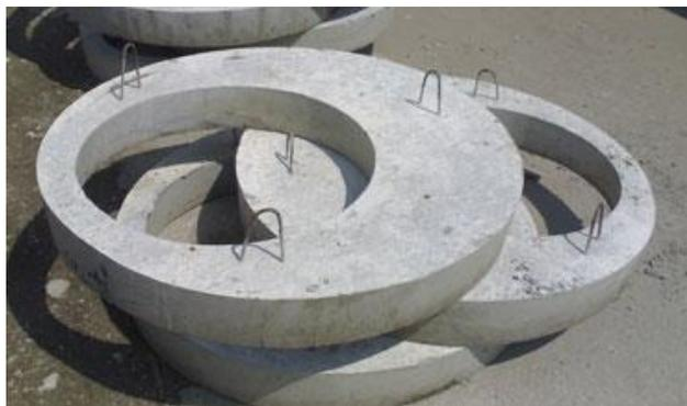
Крышка колодца (плита перекрытия) одна из составных частей при строительстве любого колодца. Предназначена для доступа во внутрь колодца, чтобы обеспечить нормальное его функционирование. Представляет собой — железобетонные изделия с отверстием под люк. Производится из армированного бетона. Устанавливается на заключительной стадии монтажа колодца. Защищает всю конструкцию железобетонного колодца. В крышку колодца встраивается люк.
